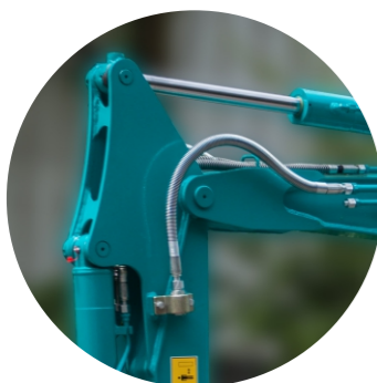
Protezione dei tubi in acciaio
